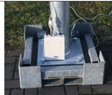
Abbildung 5 Unser kleines SDR (NI USRP) welches eine statische hochfrequente WGS84-GPS Koordinate erzeugt. Das HF-Kabel geht direkt oben an den GNSS Eingang der RSU (siehe Pfeil)
