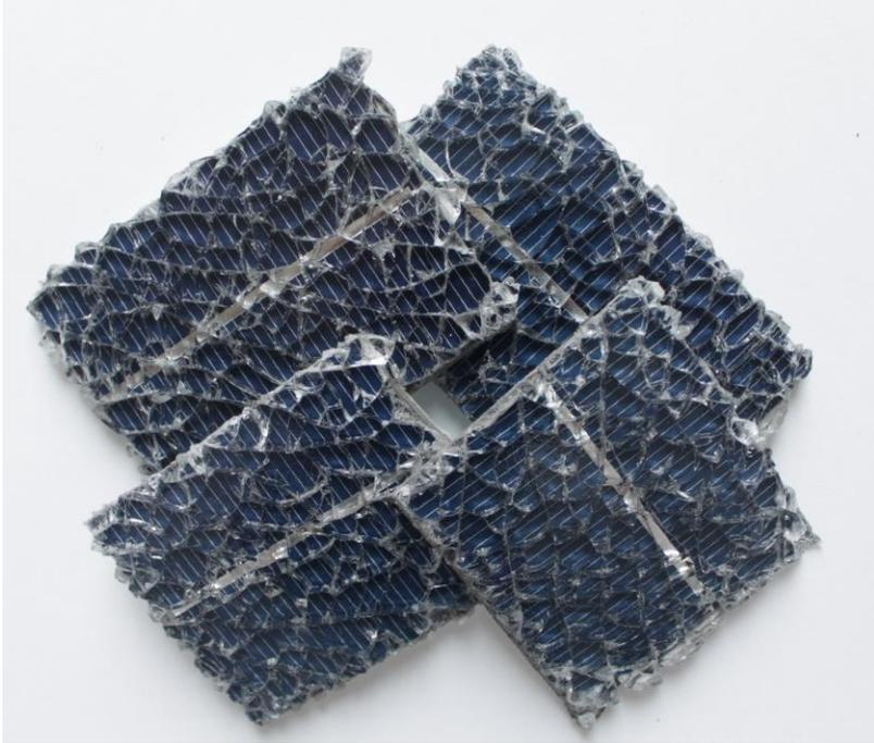
Bild: polykristallines Siliziummodul vor der Schockwellenbehandlung
