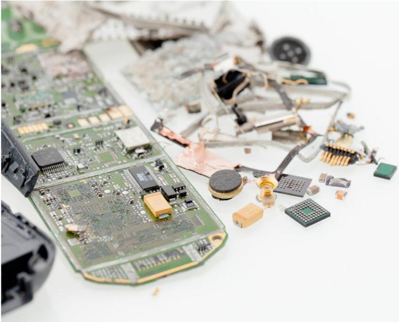
Bild: Leiterplatte eines Handys nach der Schockwellenbehandlung
