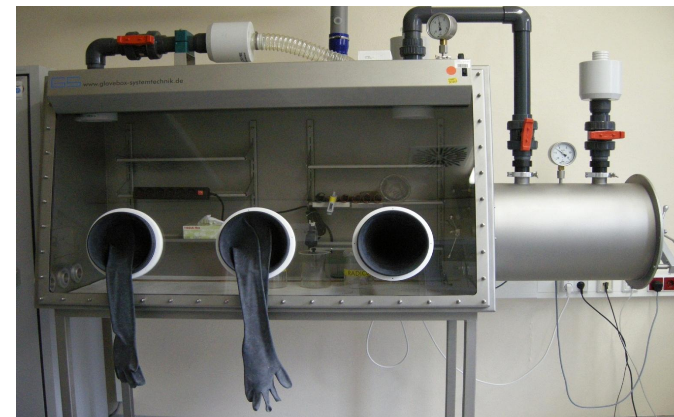
Verpacken der beschichteten Implantate unter Schutzgas
