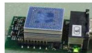
**Netzwerkknoten basierend auf Al<sub>2</sub>O<sub>3</sub>-Technologie**
