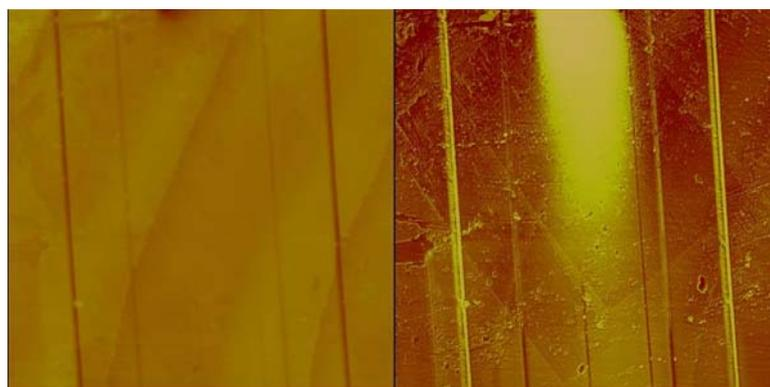
Abb. 6: AFM(links)- und AFAM(rechts)-Bilder der Probe. Die Anregungsfrequenz beträgt 685 kHz, die Scanfläche  $30 \times 30 \mu\text{m}^2$ , die z-Skalen 300 nm in der Topographie und 10 V im AFAM-Bild. Die Kante des Wafers liegt unterhalb der unteren Linie der Scanfläche.
