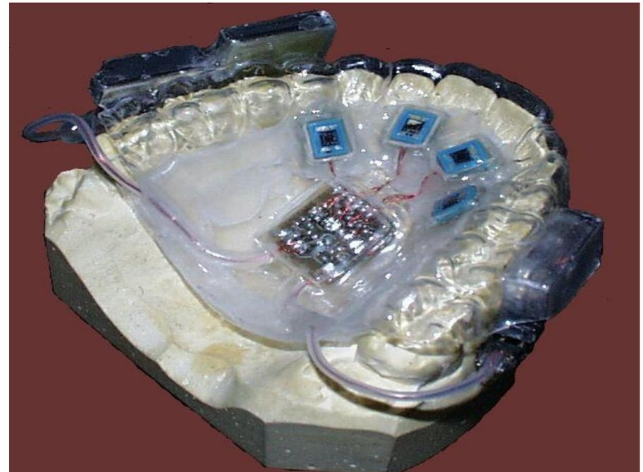
Zahnspange mit 4 Silizium-Sensoren für die Zungendruckmessung (2008)
