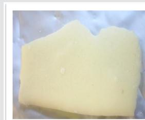
Das PYCO-PCM-1 basiert auf dem kommerziellen Salzhydrat, welches durch Zugabe von geeigneten Additiven modifiziert wurde. Hierdurch konnte eine effiziente thermische Leistung erreicht werden.
