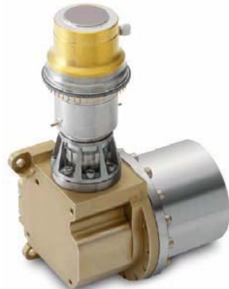
QWIP IR Photodetector (384x288 Pixel) Pixelraster: 25 \mu\text{m} NETD: < 35 \text{ mK} (Detektortemperatur: 73 \text{ K} ) Quelle: SOFRADIR (Frankreich)
