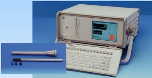
Gammasonde – drahtgebunden an Steuer-PC
