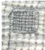
Gestickte kapazitive Tasten (Kupferdraht, Kohlenstofffaser)
