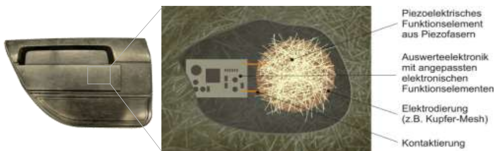
Schematische Darstellung eines prozessimmanent integrierten Sensors in aktivem GPV
