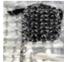
Gestickte kapazitive Tasten (Kupferdraht, Kohlenstofffaser)
