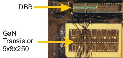
Trapezverstärker mit GaN Transistor
