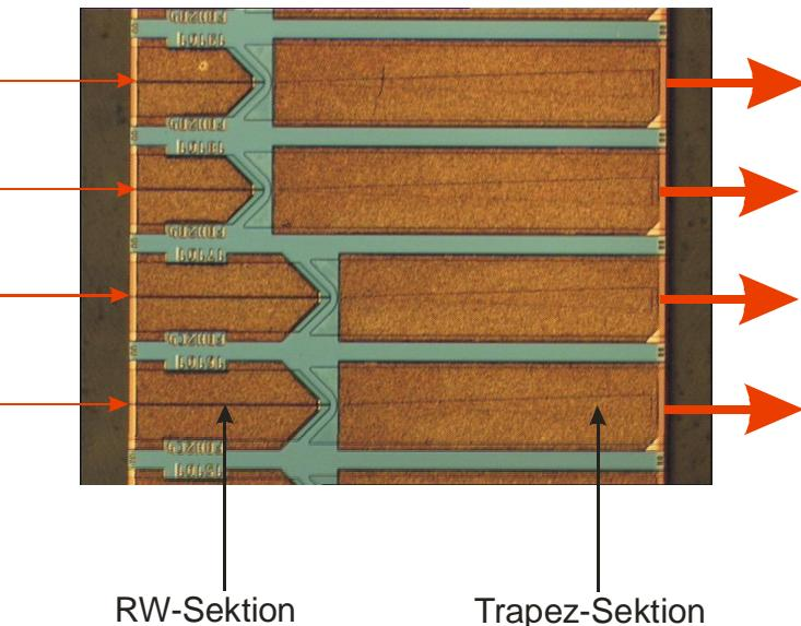
DBR Laser mit GaN Transistor
