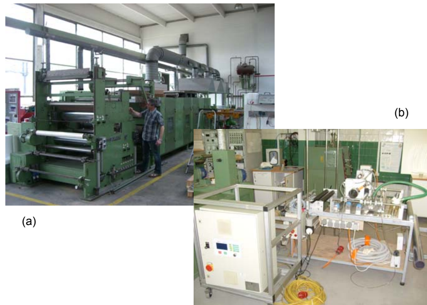
Abb. 7: (a) Pilot- und (b) Labor-Beschichtungsanlage St. Petersburg
