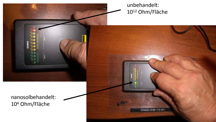
Abb. 8: Verbesserung der elektrischen Leitfähigkeit durch Nanosolbehandlung
