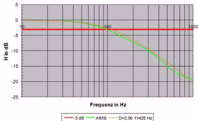
Abb. 7: Übertragungsfunktion des Neigungssensors AIM5i
